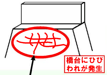
橋台の損傷（ひびわれ）
